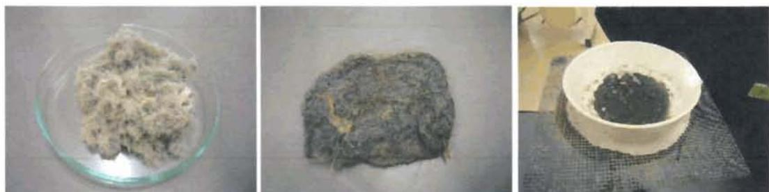
図 5 ホコリをマット化した様子（左：もとのホコリ、中央：水を加えたところ、右：蒸発皿で加熱し水分を飛ばしている様子）
