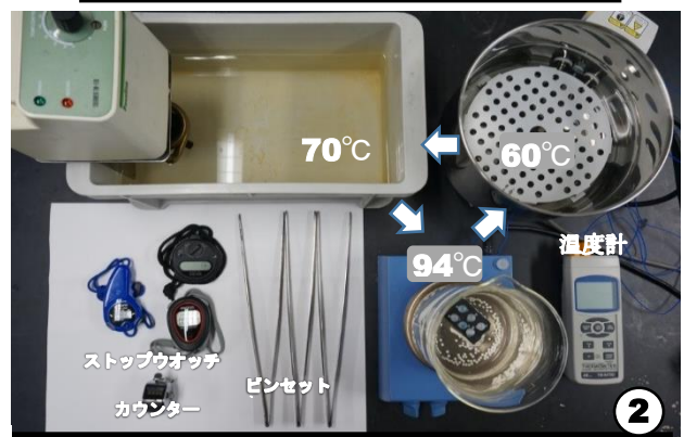
図 1-1, -2, -3 手動 PCR に用いた水槽; -4 フロートラックに装着した反応チューブ, s, スターラー.
