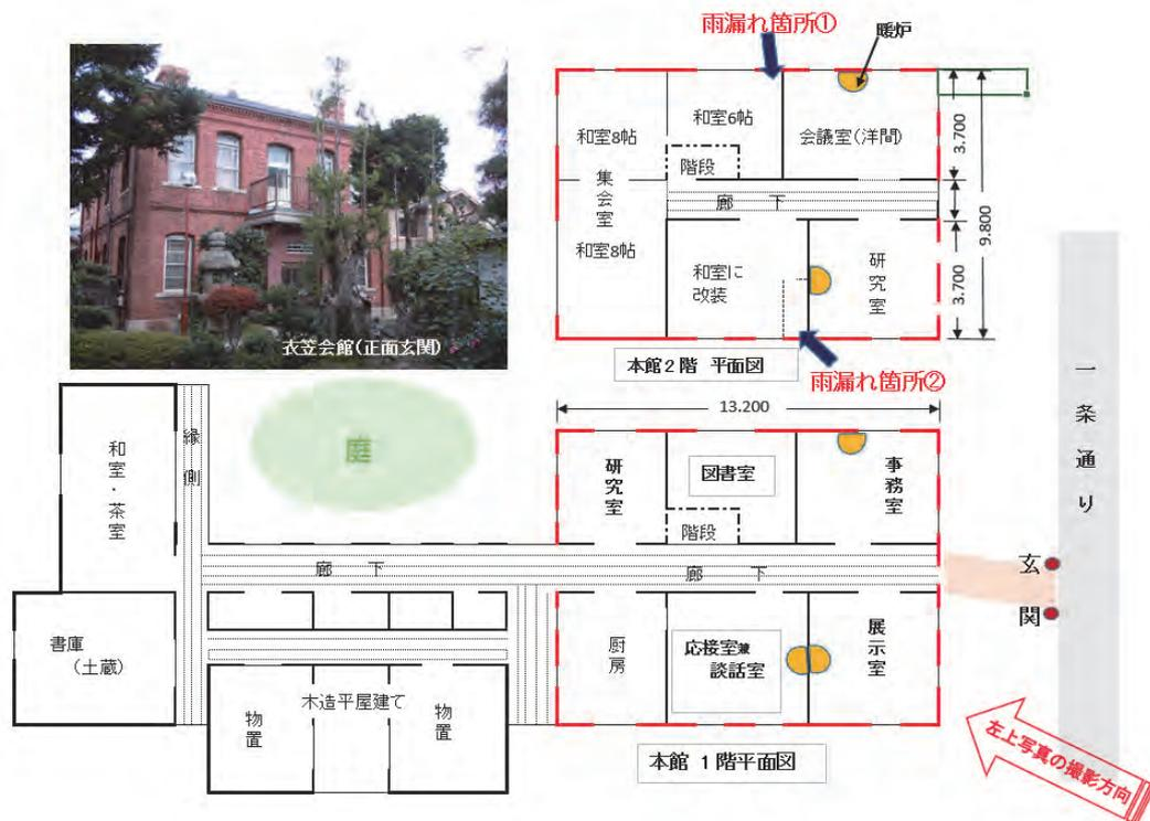
図-1 会館平面図と、修繕申請箇所(雨漏れ箇所①と②)
