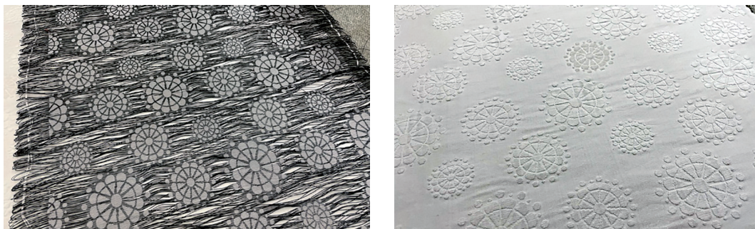
図 10. 幾何学模様柄の輪奈ビロード (左) 針抜き前 (紋切り部分はない) (右) 針抜き後
